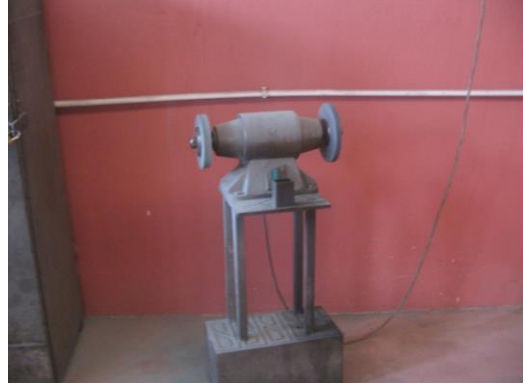
Koruyucuları olmayan zımpara taşı
