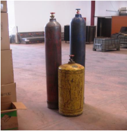
Kaynak tüpleri korumasız durumdadır ve başlıkları takılı değildir.
