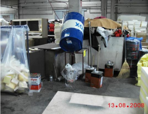
Yanıcı ve parlayıcı malzemeler bir arada bulunmaktadır.
